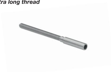
Eine Weiterentwicklung unserer Mini-Ausführung Typ KW ist die Super-Mini-Ausführung, die noch ein wenig filigraner ist. Der Gewindedurchmesser nähert sich dem Seildurchmesser weiter an und ist zwei Größen kleiner als bei der Standardausführung, z.B. M 5 für 4 mm Seil anstelle von M 8 für 4 mm Seil. Die Einstecktiefe  $L_2$  wurde noch einmal verringert, doch die Haltbarkeit bleibt erhalten. Diese Angaben gelten für Seile EN 12385-4 6 x 7-WSC und 6 x 19 M-WSC.
