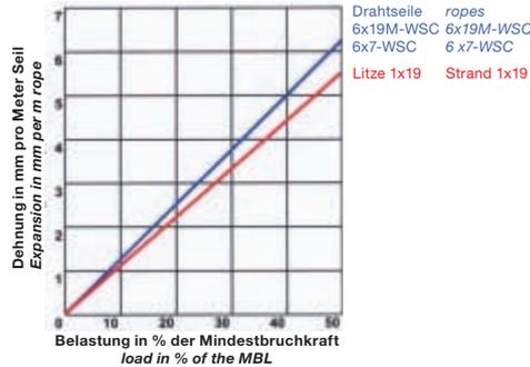
Edelstahlseile für Geländerausfachungen müssen einer Streckenlast von 1,0 kN/m widerstehen können. Da die Seile als biegeschlaffe Elemente keine Querkräfte aufnehmen können, entsteht durch die Querbeanspruchung eine Längskraft im Seil, die in die Geländerpfosten eingeleitet werden muss. Mit steigender Seillänge wächst die Längskraft im Seil an. In der nachstehenden Tabelle finden Sie die aus unseren Berechnungen und Erfahrungswerten maximalen freien Spannweiten.
