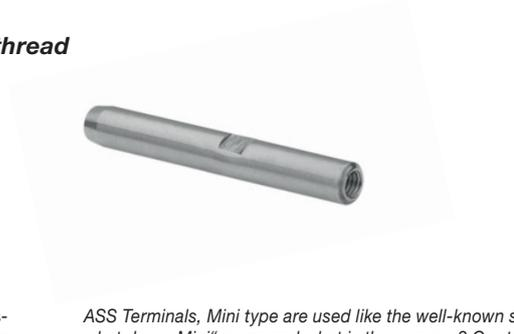
ASS Mini-Terminals werden eingesetzt, wie die bekannte Standardausführung. Doch was bedeutet „Mini“ und wofür steht es? Unsere Terminals in der Mini-Ausführung sind für die Seildurchmesser 3 mm bis 10 mm lieferbar. Der Gewindedurchmesser ist immer eine Größe kleiner als bei der Standardausführung, z.B. M 6 für 4 mm Seil anstelle von M 8 für 4 mm Seil. Ferner ist die Einstecktiefe  $L_2$  geringer, bei gleicher Haltbarkeit. Diese Angaben gelten für Seile EN 12385-4 6 x 7-WSC und 6 x 19 M-WSC.
