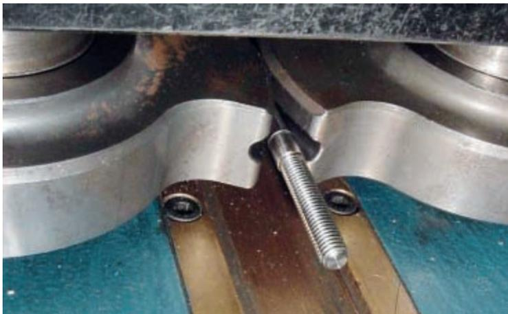
Bitte beachten Sie, dass unsere Terminals nur mit Pressen oder Walzmaschinen montiert werden können. Preßzangen sind hierfür ungeeignet!
