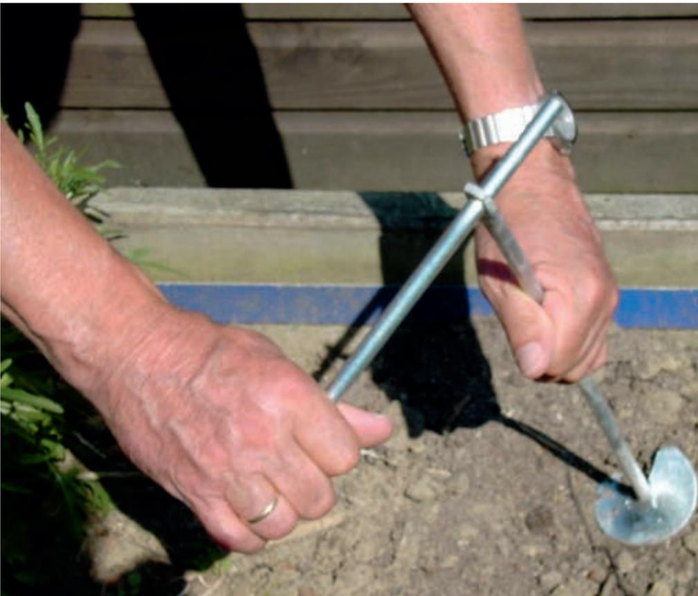
Eindreihen des ASS Erdankers mittels der Eindreihhilfe
